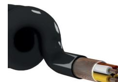
... wird als ungeschirmte oder auch geschirmte Variante, z. B. in der Medizintechnik, für Maschinensteuerungen und im KFZ-Bereich, für Messgeräte und Positionsschalteranschlüsse eingesetzt. Durch den PUR-Außenmantel und die Semocore Aderisolation werden auch für Spiralkabel mit einem Aderquerschnitt von 0,14 bis 0,50 mm<sup>2</sup> hohe Rückstellkräfte und eine lange Lebensdauer erreicht.
